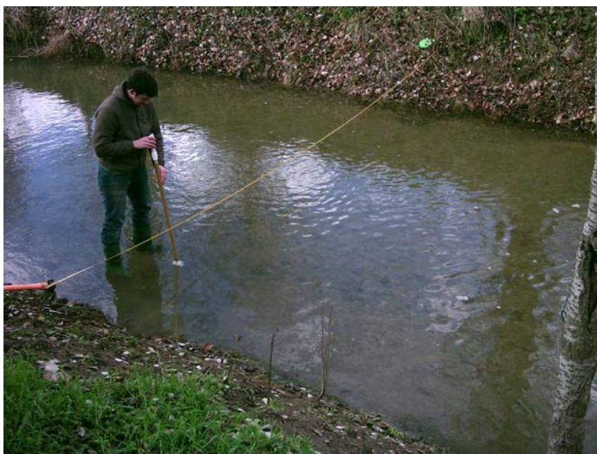
Fotografía 1. Aforo en el río Záncara. Método del molinete.
